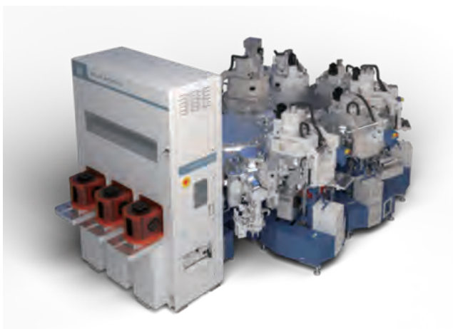
应用材料公司专为 PCRAM 和 ReRAM 打造的 Endura® Impulse™ PVD 平台
