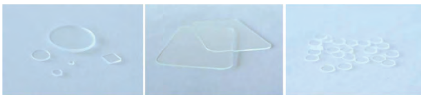
显微镜载玻片、透镜和显示器：M-Cut激光切割工艺在工件的几何形状方面没有任何限制 （图片来源：Manz集团）
