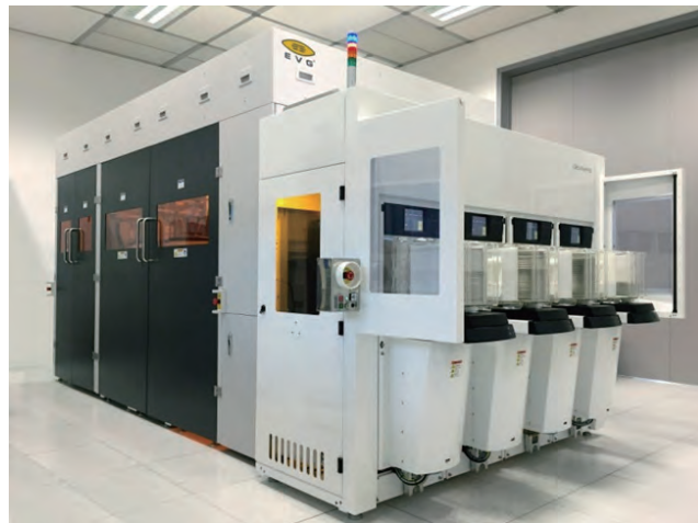
EVG GEMINI FB XT 自动化生产熔接系统
